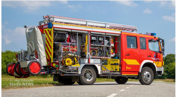
**Hilfeleistungslöschgruppenfahrzeug | HLF 20/16 der FF Stockelsdorf 83/48/01 / Foto: Jörg Schiessler/Stodo.NEWS**
